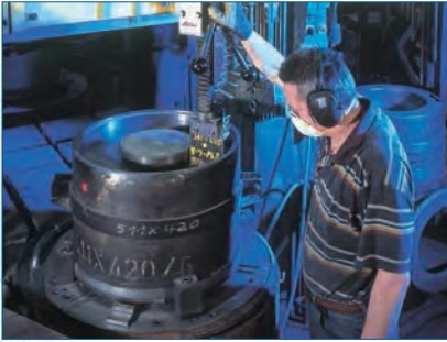
按照加工工艺压制砂轮
