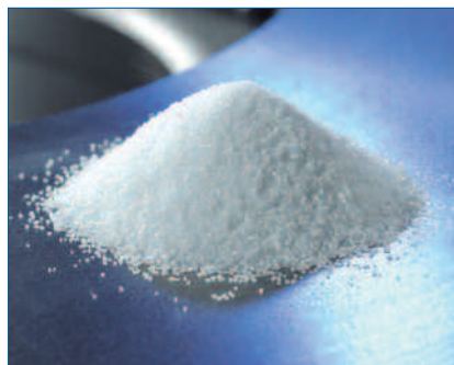
Corindo nobre 99,5 % Al_2O_3 designação resumida: EK 1
