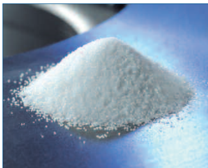
Electrocorindon nobil alb 99,5 % Al_2O_3 Prescurtare: EK 1
