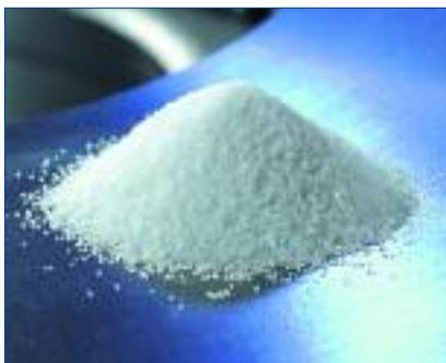
Edelkorund 99,5 % Al_2O_3 Kurzbezeichnung: EK 1
